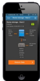
Приставка VE.Bus Smart Вимірює напругу і температуру акумулятора і дозволяє контролювати і контролювати пристрої Multi і Quattro за допомогою смартфона чи іншого гаджета з Bluetooth.
